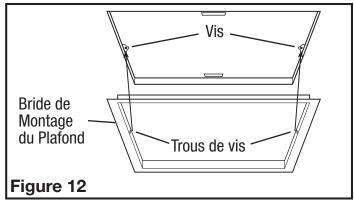
**REMARQUE:** Si le boîtier est monté très loin ou pas assez loin dans le plafond pour pouvoir fixer solidement la bride, desserrez le canal de montage et ajustez le boîtier vers le haut ou vers le bas sur les rails. Une fois en place, serrez les écrous de montage du canal.
