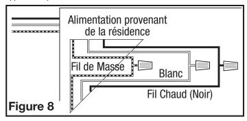
**REMARQUE**: Les fils du réceptacle du ventilateur pourraient nécessiter d'être tirés à l'extérieur du compartiment pour le raccordement. Tirer uniquement les trois fils lâches à l'extérieur du compartiment. Des fils additionnels y sont présents.
