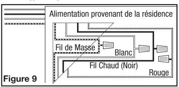
Regrouper soigneusement les fils à l'intérieur du compartiment pour le raccordement et replacer le couvercle du compartiment en le fixant avec la vis qui fut enlevée précédemment.
